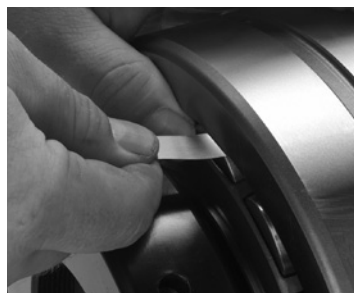
Rys. 18. Pomiar luzu wewnętrznego przed montażem.
