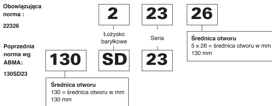
Rys. 24. Zależność oznaczeń pomiędzy normami ISO a ABMA.
