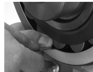
Rys. 15. Podczas montażu należy sprawdzić luz promieniowy pod nieobciążonym waleczkiem.
