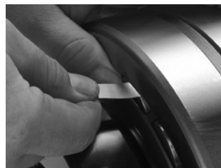
Rys. 14. Pomiar luzu promieniowego przed montażem.
